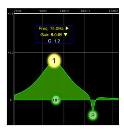
En ciertos casos, puede ser necesario ajustar la ganancia sin alterar la frecuencia. O bien, ajustar la frecuencia sin cambiar la ganancia. En ambos casos, utilice las funciones "Gain Lock" (Bloquear ganancia) o "Frequency Lock" (Bloquear frecuencia). Estos botones se encuentran en la parte superior del gráfico del EQ.
