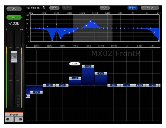
El nombre, color, fader, indicadores de nivel y botones [ON] y [CUE] se muestran en la columna izquierda. En la parte inferior izquierda verá los botones "anterior" y "siguiente" para navegar por los diferentes canales. Al pulsar estos botones solamente se podrá acceder a otros canales que tengan asignados ecualizadores gráficos.
