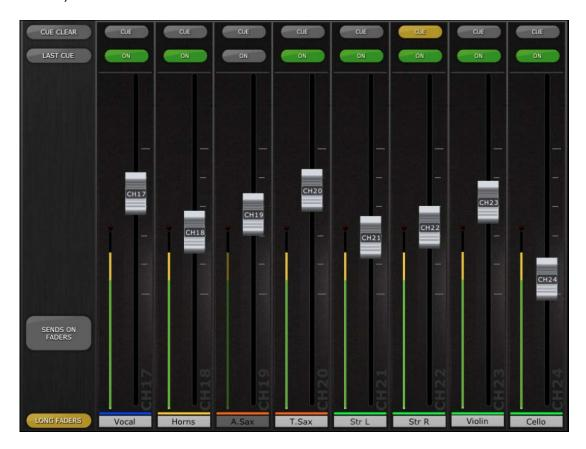
Pulse de nuevo el botón [LONG FADERS] (faders largos) en la esquina inferior izquierda para volver a Mixer Overview (Descripción general del mezclador).
