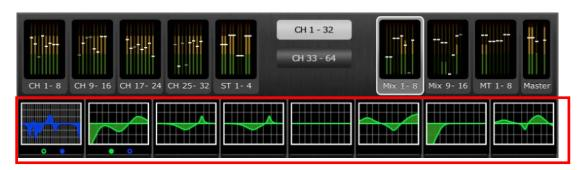
Los puntos verdes y azules debajo de cada curva de ecualizador indican los tipos de ecualizador disponibles en cada canal, así como el tipo de ecualizador (PEQ o GEQ) actualmente visualizado de dicho canal. Un punto verde indica un PEQ, y uno azul un GEQ. Si un canal dispone en ese momento de solamente un PEQ, no aparecerán puntos debajo de la curva. (En el modo de demostración, los GEQ aparecen en los buses de mezcla 1, 7 y 8).
