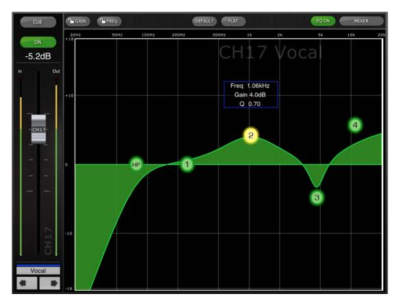
El nombre, color, fader, indicadores de nivel y botones [ON] y [CUE] se muestran en la columna izquierda. En la parte inferior izquierda verá los botones "anterior" y "siguiente" para navegar por los diferentes canales.
