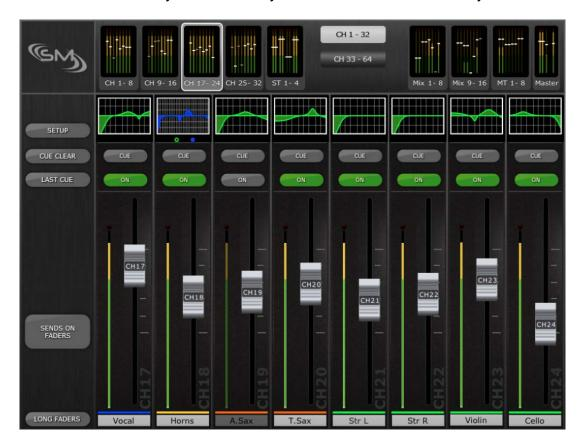
En la parte superior de la pantalla, aparecen los medidores de nivel y los faders en bloques de ocho para los canales de entrada mono del 1 al 32, los canales de entrada estéreo del 1 al 4, los buses Mix y Matrix, y los buses Master Stereo y Mono. Se trata del área "Navigation/Meter Bridge" (Navegación/Puente de vúmetro).
