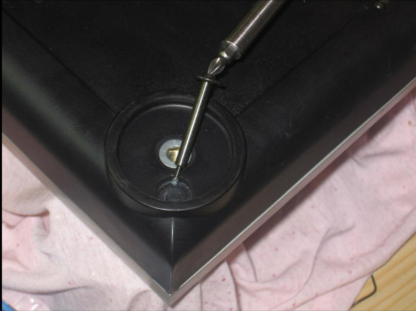
Colocamos las patas, instalamos de nuevo la plataforma giratoria y el patinador, colocamos el contrapeso y la aguja, regulando tanto el peso como el antiskating, enchufamos a la red con el plato apagado, conectamos RCA y tierra, y encendemos el plato.
