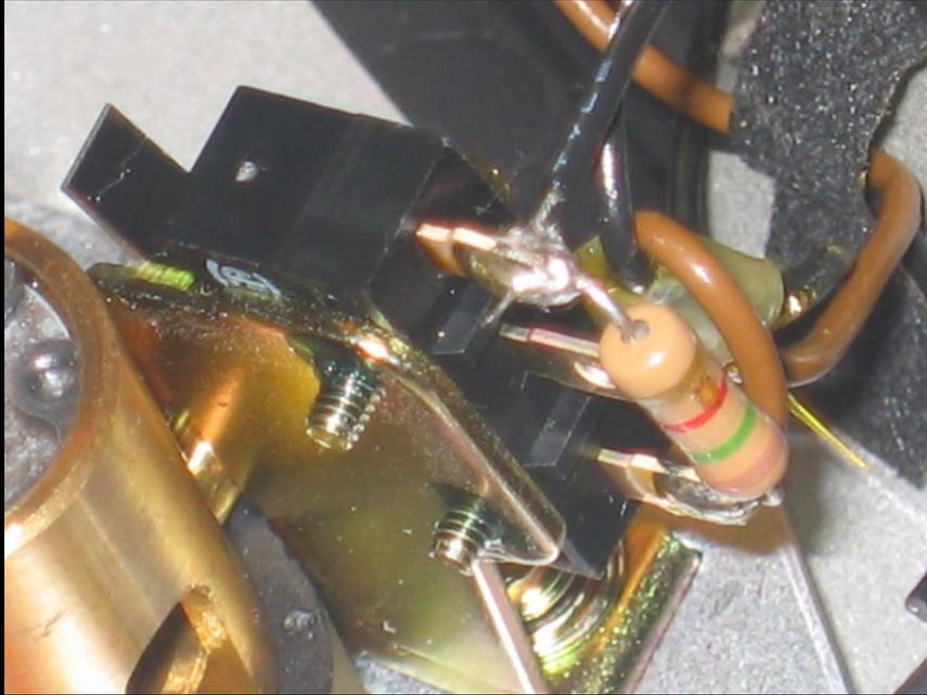
Para soldar el otro cable, pelamos el trozo del original que dejamos cortado, y el nuevo, más o menos con la misma medida. Introducimos alguno de los dos cables dentro del material termorretráctil:
