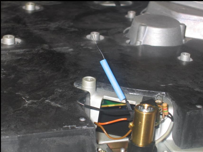
En mi caso, el cable original era multihilo, y el de la nueva bombilla, sólo de un filamento. Para que la soldadura quede homogénea y suave, recomiendo "abrazar" con los hilos el cablecillo "single". Así podremos aplicar el estaño con más facilidad. Soldamos ambos entre
