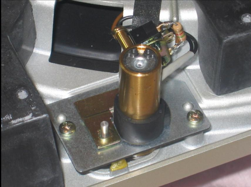
Retiramos ambos, y tiramos con suavidad de todo el bloque en vertical, para desprenderlo de la carcasa del plato:
