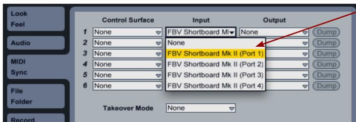
Selecciona el primer puerto FBV en este menú Input de la parte superior. Deja el resto de menús de control de Surface, Input y Output ajustados a “None” para que Live sólo reciba datos del control MIDI de tu FBV
