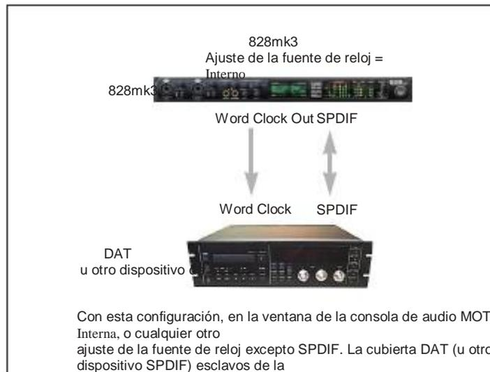
Con esta configuración, en la ventana de la consola de audio MOTU, elija Interna, o cualquier otro ajuste de la fuente de reloj excepto SPDIF. La cubierta DAT (u otro dispositivo SPDIF) esclavos de la 828mk3 a través de word clock para las transferencias de SPDIF en ambas direcciones.
