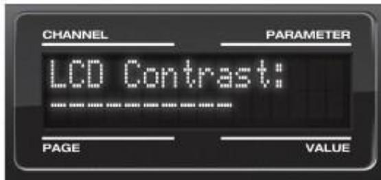
Figura 6-5: En el modo de configuración, la pantalla LCD muestra un parámetro de configuración en la fila superior de la pantalla LCD y el ajuste actual de la fila inferior.
