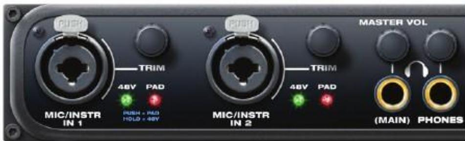
Figura 6-1: Las entradas del panel de micrófono / guitarra 828mk3 delanteros y tomas de teléfono.
