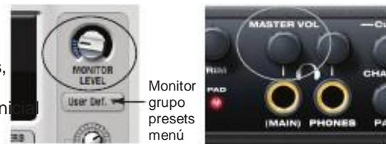
Figura 9-24: Grupo Monitor de control de volumen de CueMix FX y la panel de mando MASTER VOL frontal.
