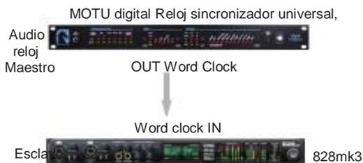
Figura 4-20: Trabajo de esclavos del 828mk3 de word clock. Para el reloj 828mk3 fuente, elija 'Word Clock In'.
