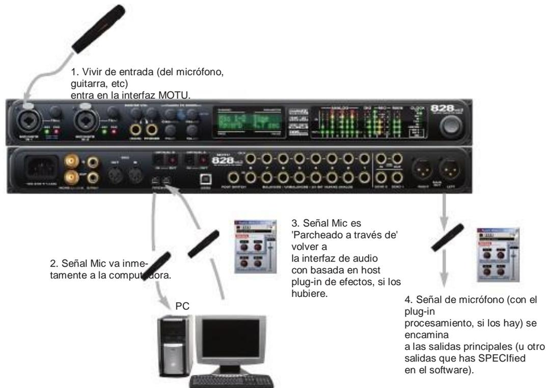
Figura 8-1: Hay dos maneras de monitorear las entradas de audio en vivo con un 828mk3: 1) a través de la computadora o 2) a través de hardware FX CueMix monitor ing. Este diagrama muestra el método 1 (a través de la computadora). Al utilizar este método, utilice ajuste de amortiguación de su software de host para reducir la ligero retraso que se oye cuando el control de la entrada en directo, pero no baje demasiado, o su ordenador puede ser que consiga lento.
