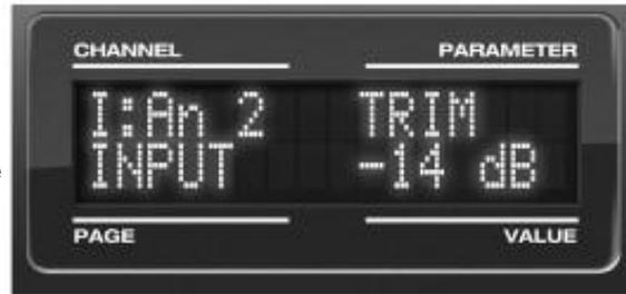
Figura 4-8: Configuración del ajuste de la entrada de un par de entradas analógicas TRS.
