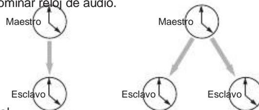
Figura 4-16: Para mantener el 828mk3-fase sincronizada con otros dispositivos digitales de audio conectados a él, eligen un reloj maestro.
