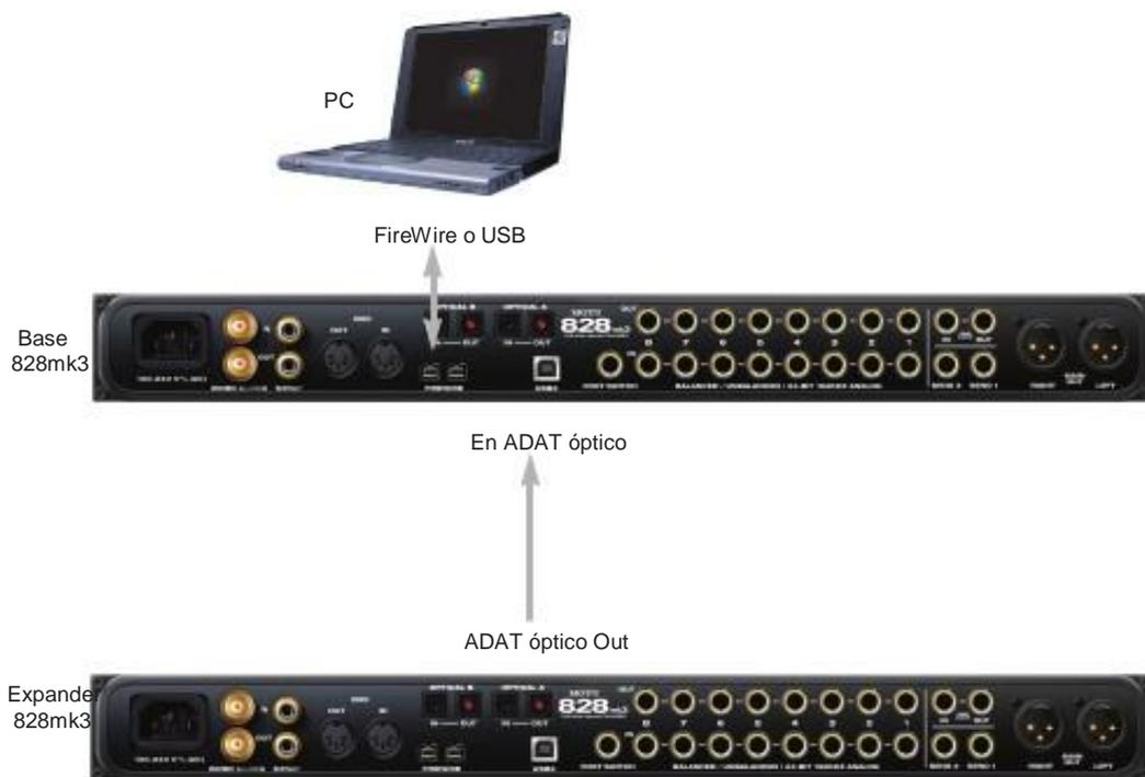
Figura 4-13: Uso de la 828mk3 como un expansor óptico. En este ejemplo, que está conectado a otro 828mk3.
