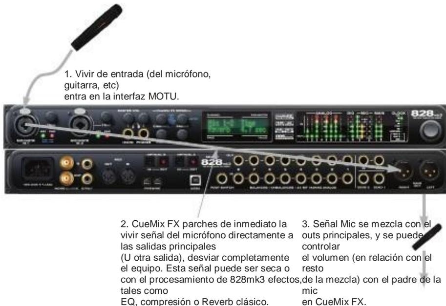
Figura 8-2: Este diagrama muestra la señal Floridaow cuando utilice CueMix FX monitoreo sin latencia. Tenga en cuenta que este método no procesa el vivir de entrada con los plug-ins en su software de audio. En su lugar, se puede aplicar 828mk3 efectos, como la reverb, EQ y / o compresión.
