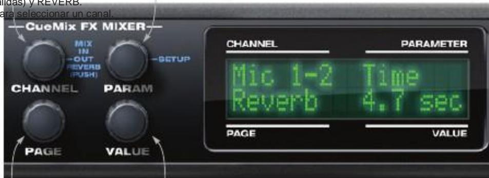
Gire el mando PAGE para ver la configuración de cada canal. Pulse para saltar a la sección siguiente o de nuevo al principio.
