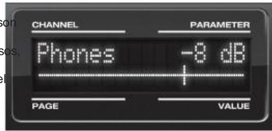
Figura 6-4: La pantalla LCD proporciona información a medida que ajusta el volumen.
