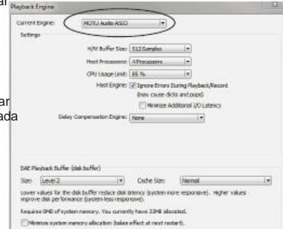
Figura 7-2: Activación del controlador ASIO MOTU Audio en Pro Tools
