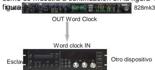
Figura 4-19: Trabajo de esclavos otro dispositivo de audio digital al 828mk3 través word clock. Para la fuente 828mk3 reloj, elegir cualquier fuente, además de reloj de palabra, ya que no es recomendable word clock cadena.
