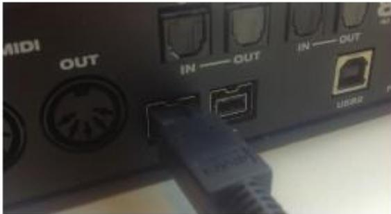
Figura 4-1: Conexión del 828mk3 al ordenador a través de FireWire.
