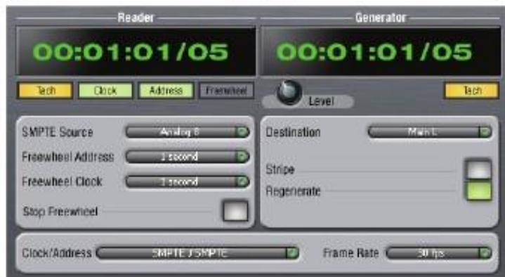
Figura 10-1: SMPTE Console le permite acceder a sus 828mk3 de a bordo Características de sincronización de código de tiempo SMPTE.
