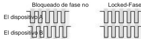
Figura 4-15: Cuando se transfieren audio, dos dispositivos deben tener la eliminación de relojes de audio bloqueados para evitar clics, pops o otros artefactos.
