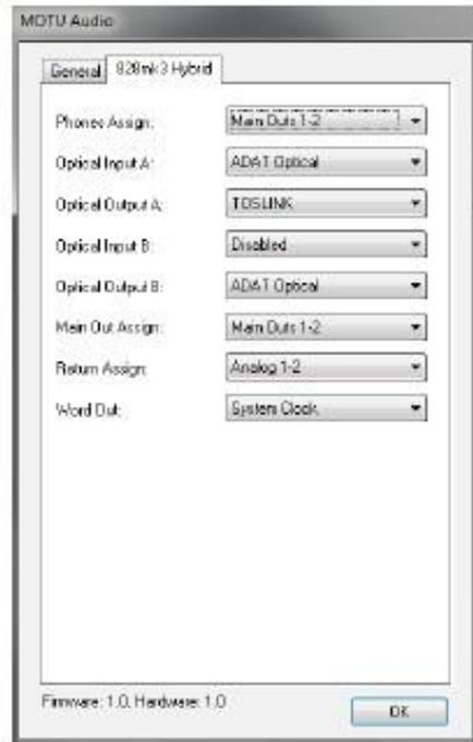
Figura 3-1: Consola de audio MOTU le da acceso a todos los ajustes en el hardware 828mk3.
