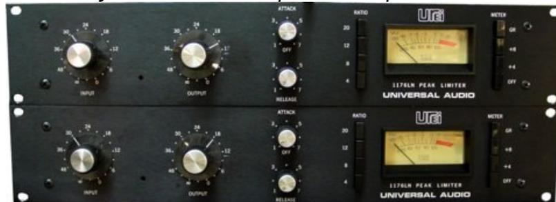
Par de compresores para configuración estéreo Urei 1176LN. Compresores del tipo FET
