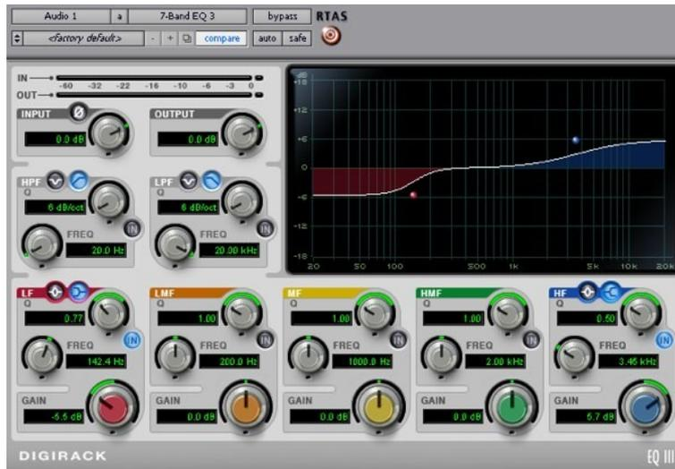
*En este ejemplo tenemos configurado el EQ3 de Digidesign con ecualización de estantería para altas y bajas frecuencias. Para el caso de las bajas frecuencias hemos hecho un recorte fijando la frecuencia del ecualizador en 142'4Hz, mientras que en el caso de las frecuencias altas existe un refuerzo por encima de los 3'45kHz fijados.*
