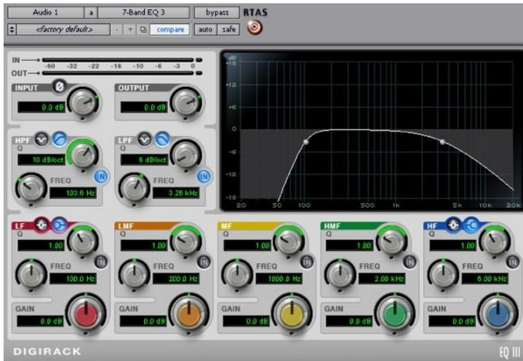
*En este ejemplo volvemos a tener el EQ3 de Digidesign, esta vez con un filtro paso-alto y otro paso-bajo. Vemos que el paso alto está configurado con una pendiente más abrupta (18dB/oct) que el filtro paso-bajo (6dB/oct).*
