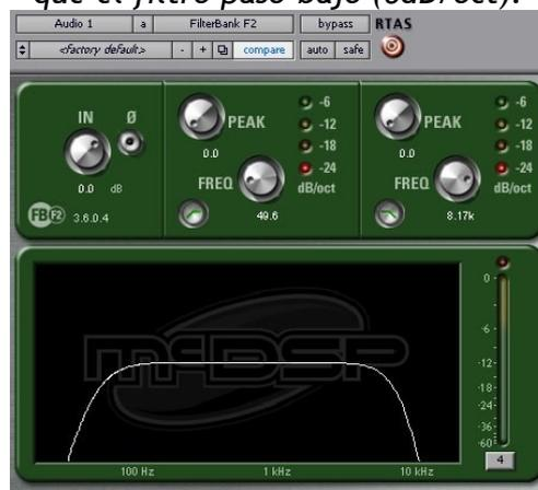
*Aquí tenemos otro ejemplo de filtros. En esta ocasión se trata de una configuración paso-bajo y paso-alto con el F2 de McDSP.*
