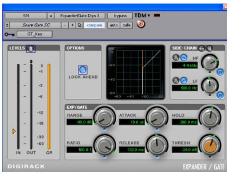
*Puerta de ruido configurada para una caja. Vemos en la parte superior derecha el filtrado de la señal de key*
