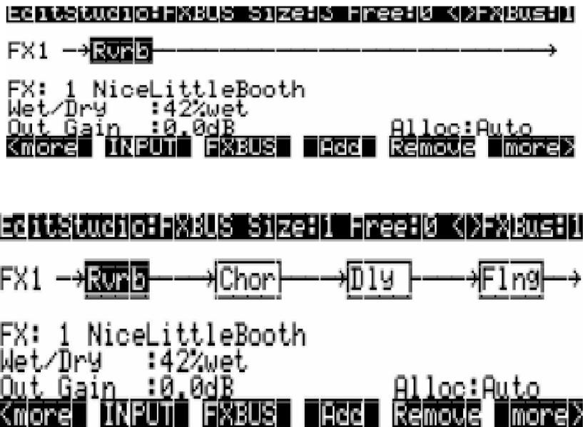
Figura 9-3 Pantalla de Editor de bus de efectos - 4 efectos en cadena
