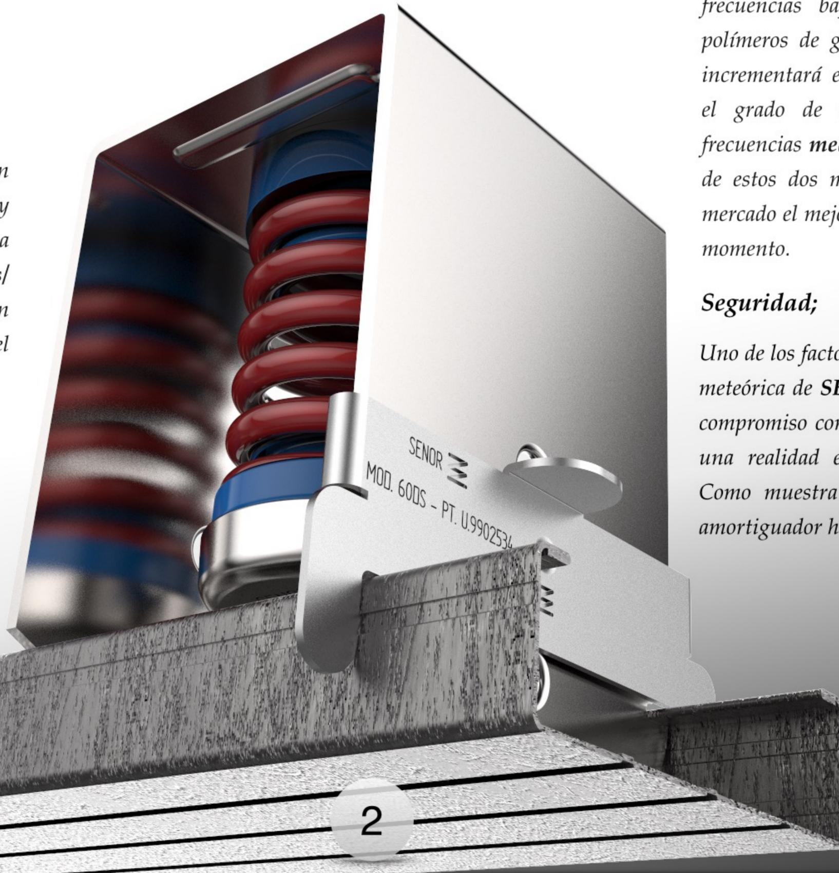
**B, Resorte helicoidal de acero;** Nos proporcionará un rendimiento excelente en las frecuencias bajas Hz y, la combinación de polímeros de gran resistencia en sus extremos incrementará el amortiguamiento, aumentando el grado de aislamiento en el régimen de frecuencias **medias/altas Hz**. La yuxtaposición de estos dos materiales hace posible sacar al mercado el mejor amortiguador a compresión del momento.
