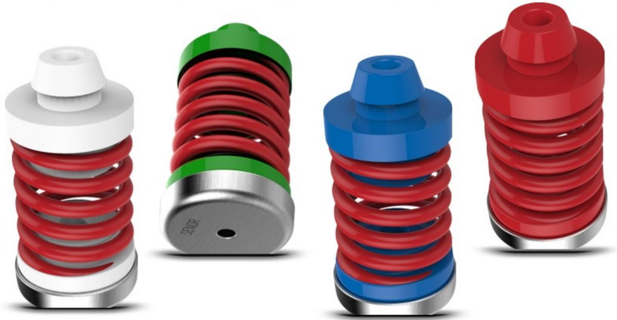
**Capacidad de carga dinámica;** Están diseñados para trabajar sometidos a cargas variables comprendidas entre los 20N hasta los 750N. El color **gris** nos identificara la carga de menor rango y el de color **rojo** el de mayor rango de carga.
