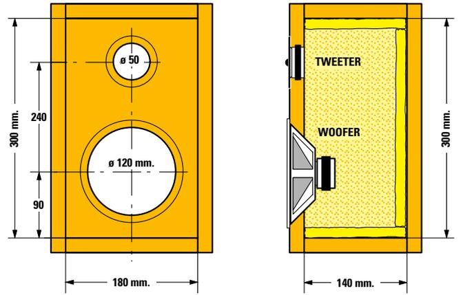
Fig.22 Mobile con un volume pari a circa 75 litri idoneo per un Tweeter e un Woofer.
