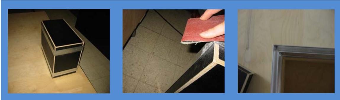
Tener en cuenta que como observamos en la tercera foto tendremos que usar una ingleteadora para hacer los cortes de 45° y que unan perfectamente para unir las esquinas, tanto para los perfiles de encaje como para los de refuerzo en los cantos.
