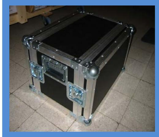
Con los remates que se observan en las fotografías siguientes hemos terminado la parte de fuera, le hemos añadido unos soportes de goma en la parte inferior del cuerpo para indicar como debe de ir colocado el flight-case-rack (segunda y tercera fotografía).
