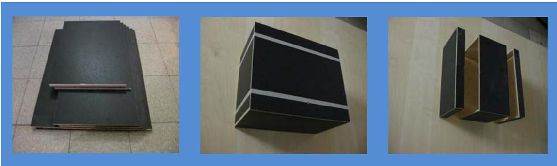
Lo primero que tendremos que hacer después de tener las maderas cortadas a la medida será hacer una “caja” cerrada en forma de “cubo” y mediante una cinta marcaremos el tamaño de las “tapas” como se puede observar en la segunda foto, quedándonos dos tapas de 6cm de grosor.
