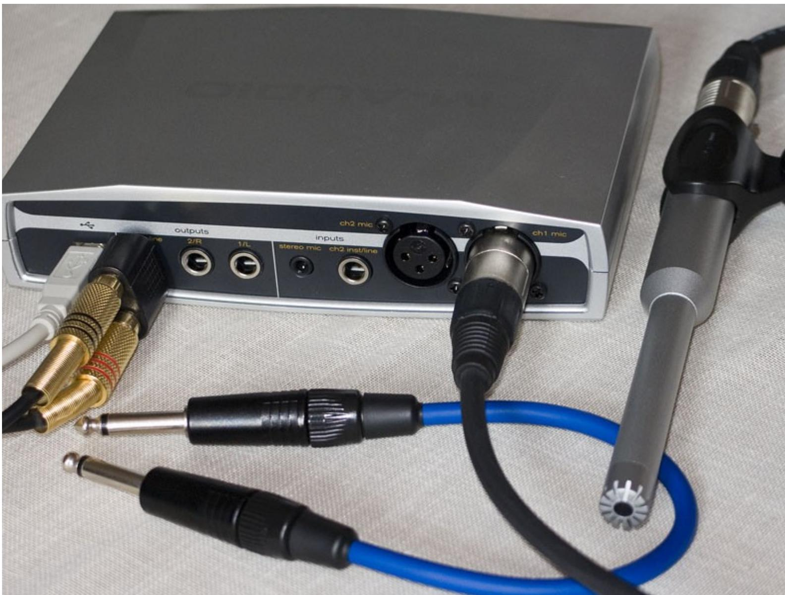
La salida de la tarjeta (a la izquierda, al lado de la conexión USB) debemos conectarla a la entrada del ecualizador que debe estar en posición "Bypass". Como vamos a medir canal por canal, de forma independiente, solo tendremos conectado en cada momento el cable del canal correspondiente.
