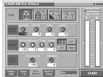
Existen 3 *pre-effects*: compresor, limitador, y supresor de ruido. Su uso le permitirá ajustar el nivel del sonido que esté muestreando.
