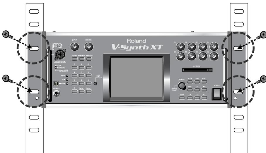
No es posible desmontar los anclajes de fijación de la unidad V-Synth XT. Además nunca afloje ningún tornillo que no sea del tipo "bloqueo por rotación", ya que puede generar un mal funcionamiento.
