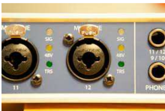
Entrada combinada que permite los tres tipos de conexión
