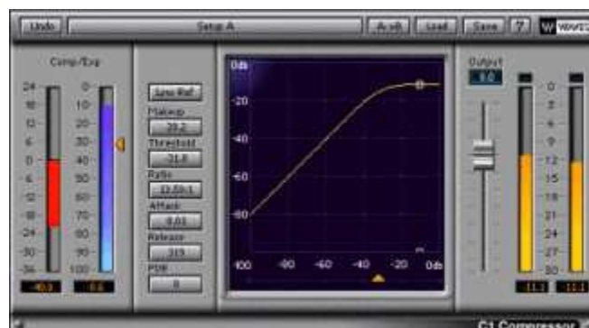
Ejemplo de plugin compresor donde podemos ver la función de transferencia (Waves C1)
