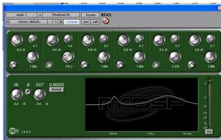
Ecualizador paramétrico P6 de MCDSP. En la configuración de la imagen vemos activas dos bandas. Una centrada en 118.3Hz, una ganancia de 4'8dB y con un ancho de banda estrecho (Q=3). La otra banda está centrada en 3'27kHz, tiene una ganancia de 5'2dB y un ancho de banda grande (Q=0'7).
