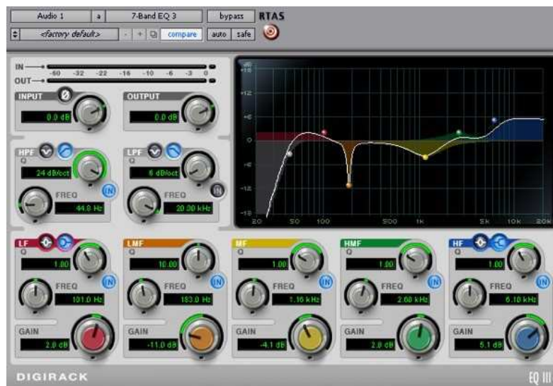
El EQ3 de Digidesign, con una configuración que mezcla todos los tipos de filtros.
