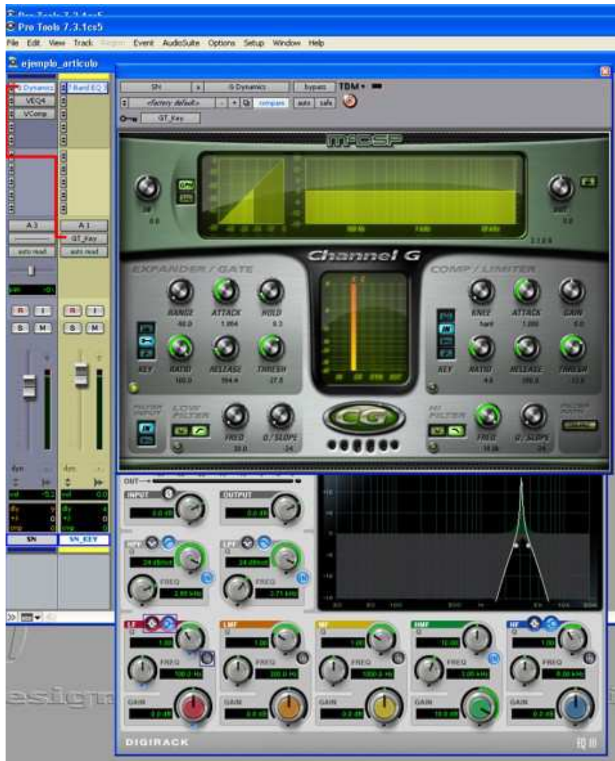
Esta imagen muestra una configuración de puerteo usando una pista duplicada y fuertemente ecualizada. Vemos como la puerta en la pista original se dispara con la salida de la pista duplicada.
