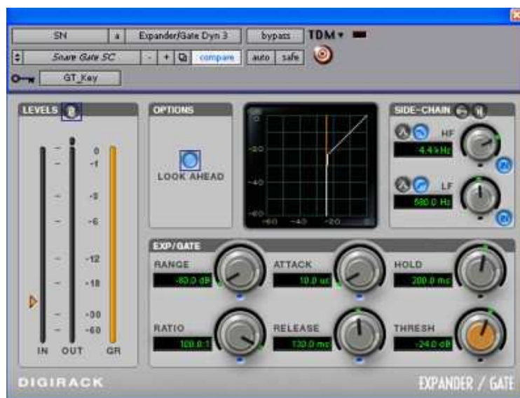
Puerta de ruido configurada para una caja. Vemos en la parte superior derecha el filtrado de la señal de key
