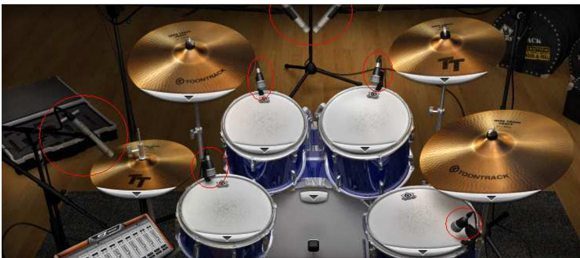
*Ilustración extraída de un conocido plugin de baterías que sirve de ejemplo de la colocación típica de los micrófonos. Fijaos en la microfonía cercana y la posición cruzada de los overheads.*
