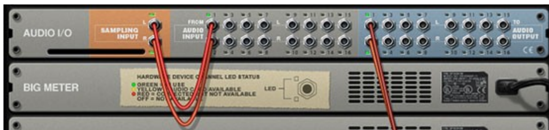
Figura 2: La ruta por defecto es la entrada de audio 1 / 2 a la entrada de muestreo L / R
