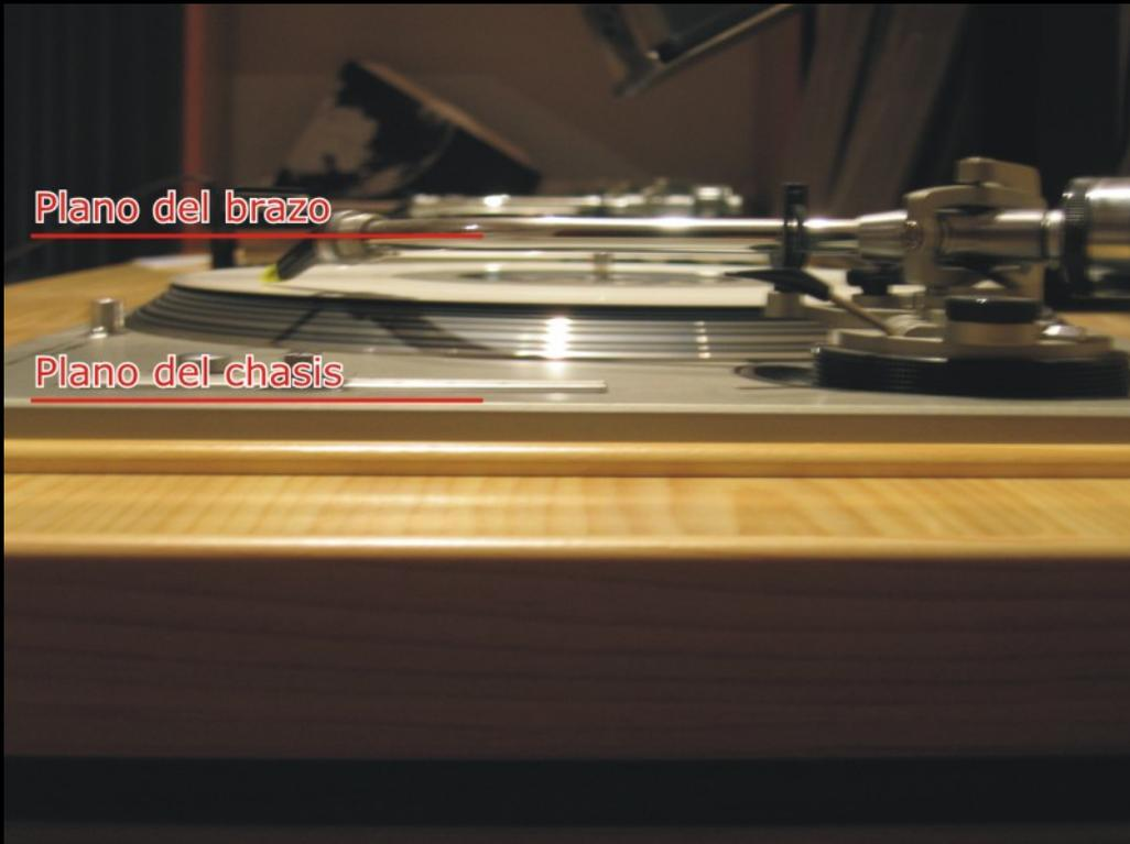
Figura 4: Plano del brazo paralelo con el plano superior de la carcasa del plato
