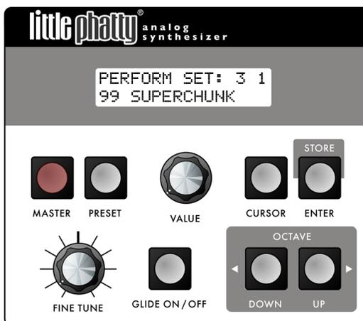
El ejemplo de la derecha muestra el preset guardado en la primera ubicación de Performance Set 3 (Preset 99 – SUPERCHUNK). Para desplazarse por esta secuencia, pulse el interruptor VALUE. Cada pulsación avanzará al siguiente preset en la secuencia. Cuando se alcance el octavo preset, la siguiente pulsación del interruptor VALUE dará la vuelta al primer preset en Performance Set 3.
