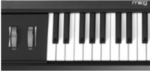
El Little Phatty lleva un teclado de 37 notas (3 octavas, Do a Do). Cuando se combina con los botones OCTAVE, el teclado tiene un rango interpretativo de 7 octavas. El teclado produce voltajes de control de velocidad, y transmite mensajes MINI de Note On y Note Off polifónicos. A la izquierda del teclado está el Panel Controlador de la Mano Izquierda, que lleva los controles de Pitch Bend y Mod Wheel.
