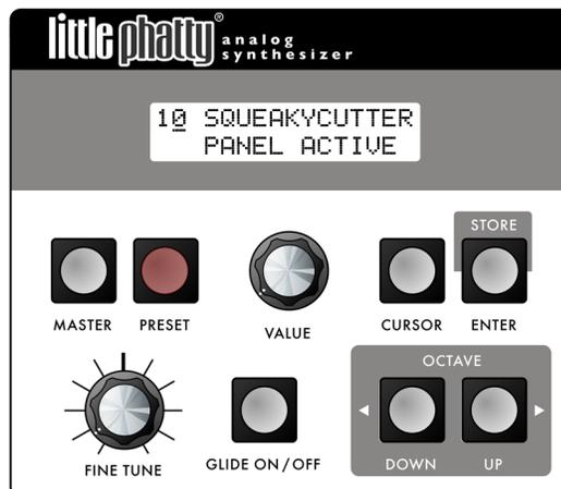
Los Preset se seleccionan usando el knob VALUE. A medida que se gira VALUE, el nuevo preset aparece en el display y está disponible inmediatamente para ser escuchado (no necesita 'activar' el preset para oírlo). Pulsando VALUE y girando el knob le hará avanzar en incrementos de diez.
