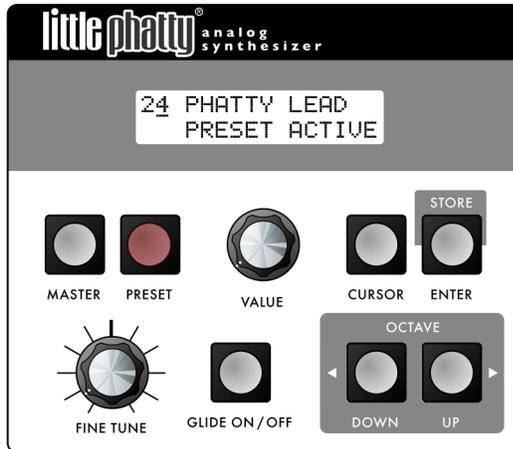
El display de estado es una pantalla LCD situada en el centro del panel encima de la sección de los controles. Cuando se enciende el LP, la pantalla mostrará el mensaje:
