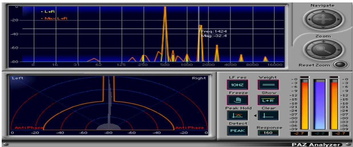
Gráfica del Hedd procesando una senoide de 500Hz a -10dB distorsionada con tape.
