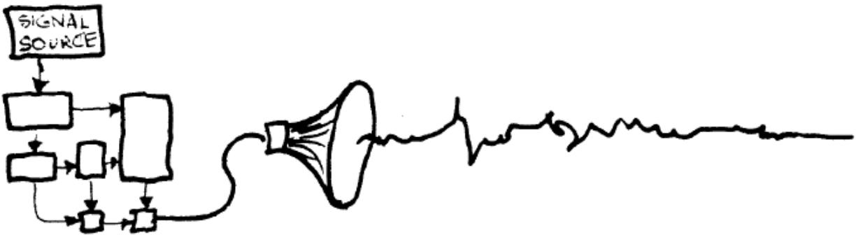
**2.331.-CONFIGURAR UN PARCHÉ** implica al menos proporcionar una ruta para las señales de audio; Además, la ruta de la señal debe comenzar en un origen de señal interno o externo.
