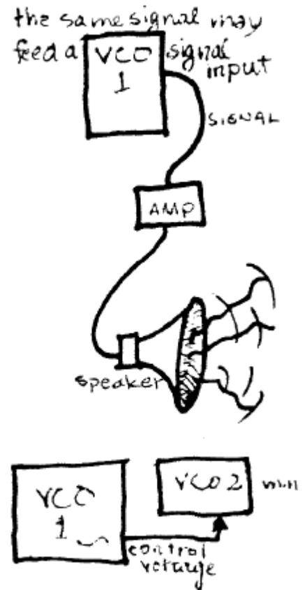
**2.3.-UN SINTETIZADOR**, consiste en equipos de GENERADORES DE SEÑALES y MODIFICADORES DE SEÑALES; Y parte de este equipo está CONTROLADO POR VOLTAJE, por señales que generalmente se generan, y también se pueden modificar, dentro del sintetizador.
