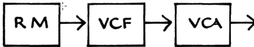
Comience con las dos señales de entrada precableadas, diente de sierra de VCO1 y onda sinusoidal de VCO2, y deje que la señal del modulador pase sin filtrar directamente a través del VCF al Mezclador. (Tenga en cuenta que nuestras conexiones precableadas también le permitirán omitir completamente el VCF utilizando la entrada de RM-VCA precableada y luego abriendo la entrada de VCA-Mixer en lugar de la entrada de VCF-Mixer).
